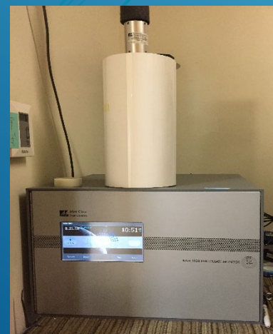
Fond du Lac's Beta Attenuation monitor.
